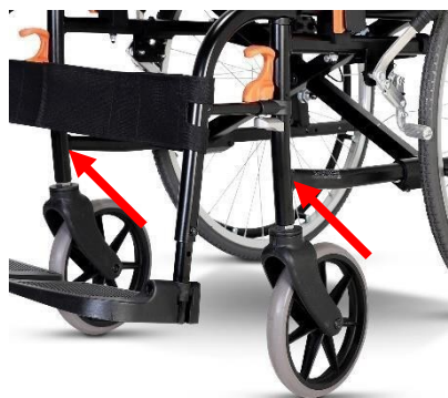
Fixační body v přední části
