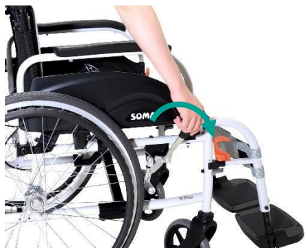
Aktivací brzdy vozík zajistíte
