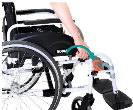
Aktivací brzdy vozík zajistíte
